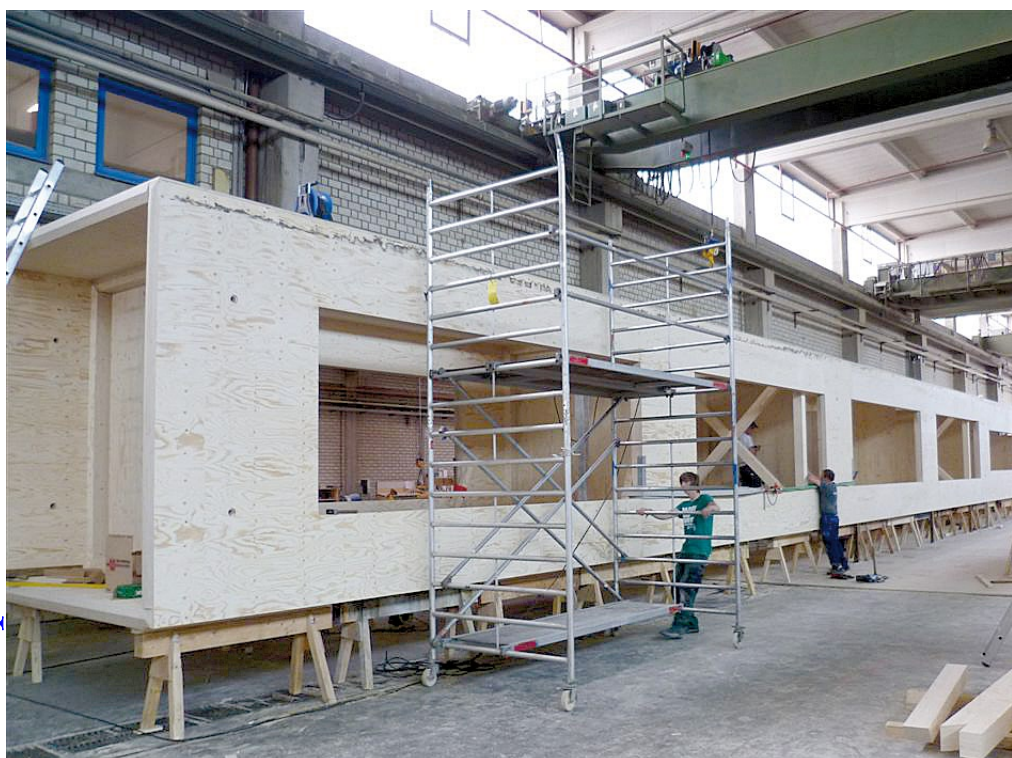
Der hölzerne Turm wurde komplett vorgefertigt und in drei Teilen auf die Baustelle geliefert.
